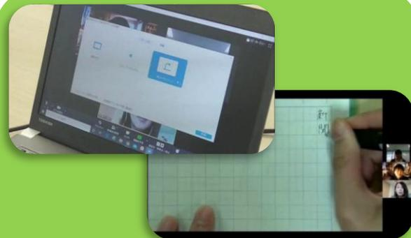
Zoomに搭載の [第2カメラのコンテンツ] 機能を利用し、先生側はWebカメラを併用して、実物投影機の映像を見せながら授業ができる！
